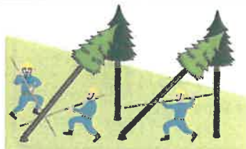
(図2)かかり木の処理
