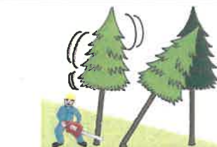
(図4)かかり木に激突させるためにかかり木以外の立木の伐倒
